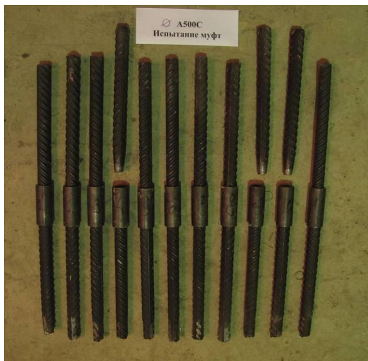
Рисунок А.6 – Вид испытанных резьбовых механических соединений «LENTON» и арматурного стержня \varnothing 36 мм на растяжение
