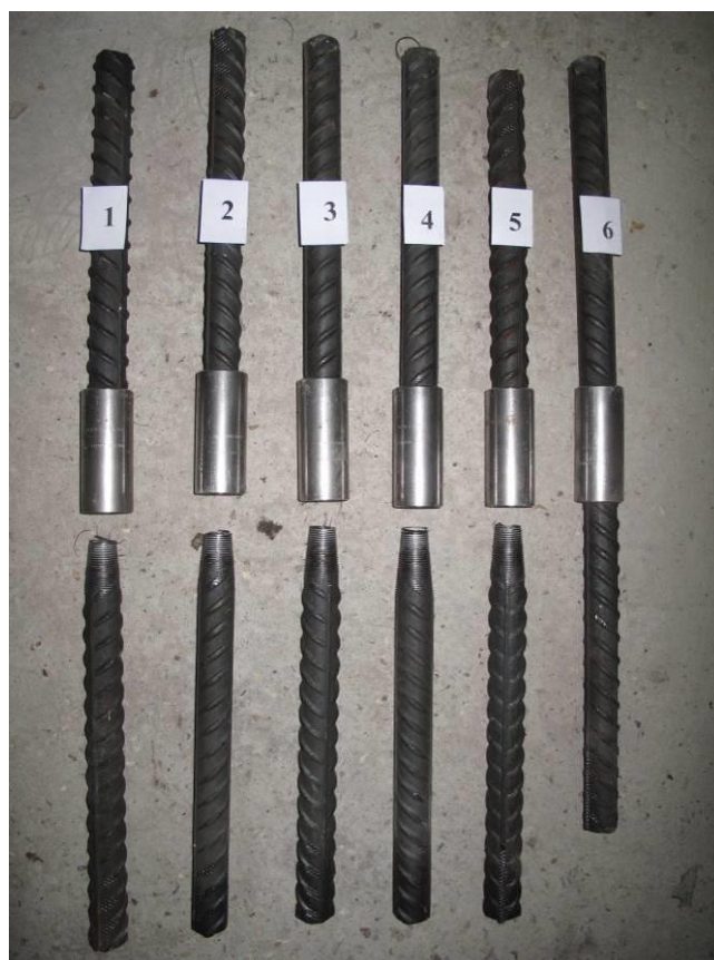
Рисунок А.5 – Вид испытанных резьбовых механических соединений «LENTON» и арматурного стержня Ø 32 мм на растяжение
