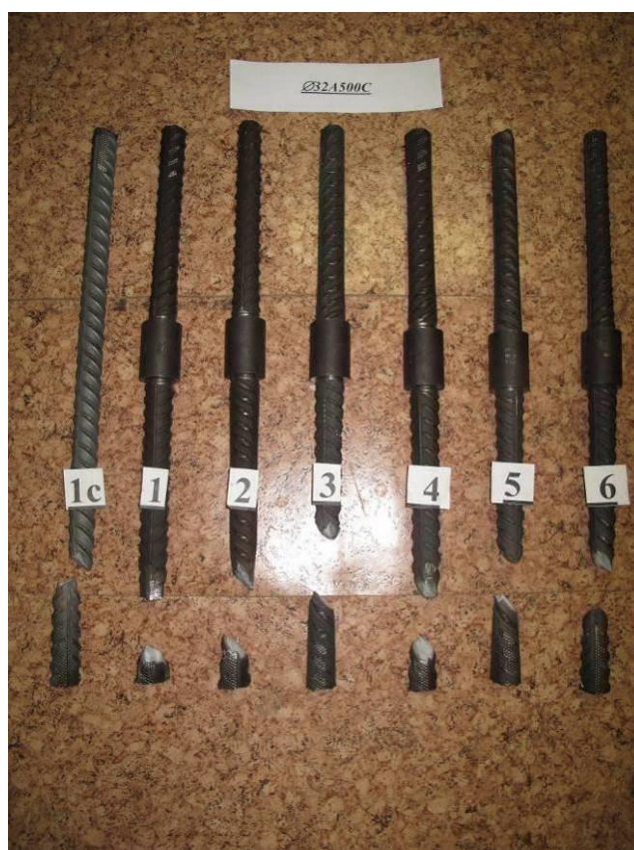
Рисунок А.11 – Вид испытанных резьбовых механических соединений «Bartec Dextra» и арматурного стержня Ø 32мм на растяжение
