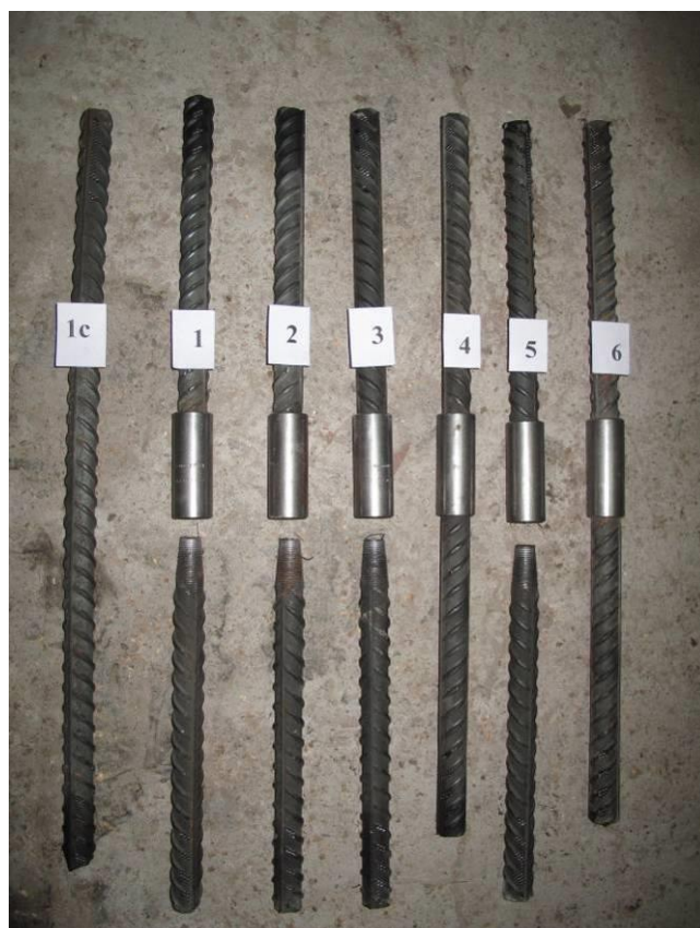
Рисунок А.4 – Вид испытанных резьбовых механических соединений «LENTON» и арматурного стержня Ø 28 мм на растяжение
