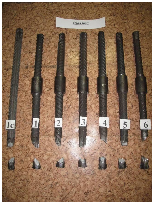
Рисунок А.12 – Вид испытанных резьбовых механических соединений «Bartec Dextra» и арматурного стержня Ø 36 мм на растяжение
