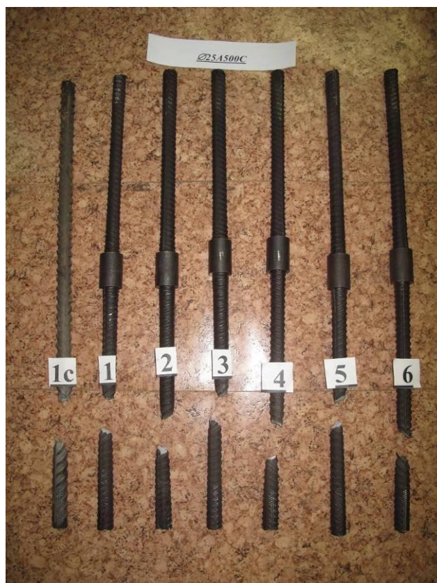
Рисунок А.10 – Вид испытанных резьбовых механических соединений «Bartec Dextra» и арматурного стержня Ø 25 мм на растяжение
